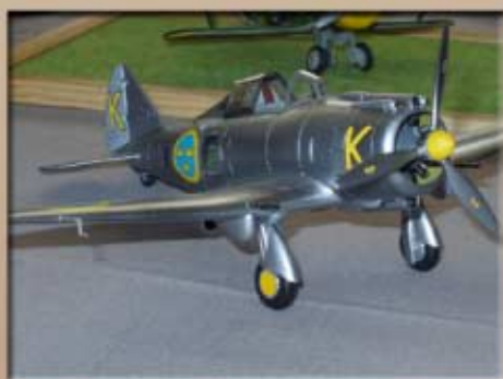
J 9 var Sveriges första moderna jaktflygplan. Lägg märke till fönstret bakom förarkabinen. Innanför fanns ett utrymme där mekaniker kunde medföras vid utbaseringar!
