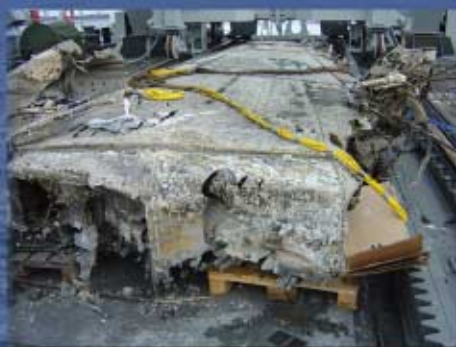
Vänster vinge, ovasida. Kraftiga brandskador.
