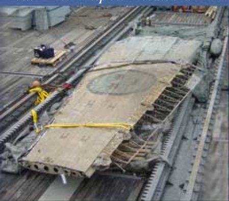
Höger vinge, undersida. Kronmärkningen syns tydligt. Vingspetsen är avbruten.
